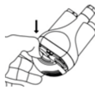
Установите фильтрующую сетку (5) крышку фильтра (6) на место.
