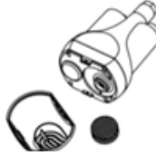
Puhdista suodatinverkko (5) ja suodattimen suojus (6).
