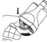
Aseta suodatinverkko (5) ja suodattimen suojus (6) takaisin paikoilleen.
